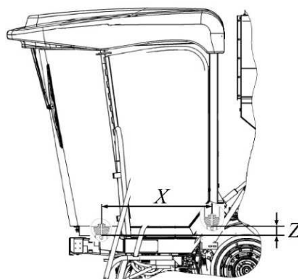
Рис. 3. Расчетная схема геометрической компоновки системы поддрессоривания кабины ЗУК: X – продольное расстояние между ВИ; Z – разность высот установки ВИ
