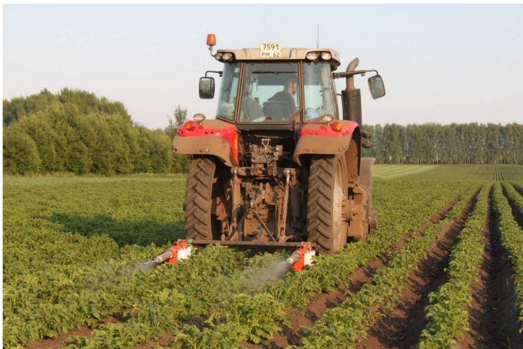
Рисунок 4 – Общий вид устройства для обработки посадок картофеля горячим туманом биопрепаратов
