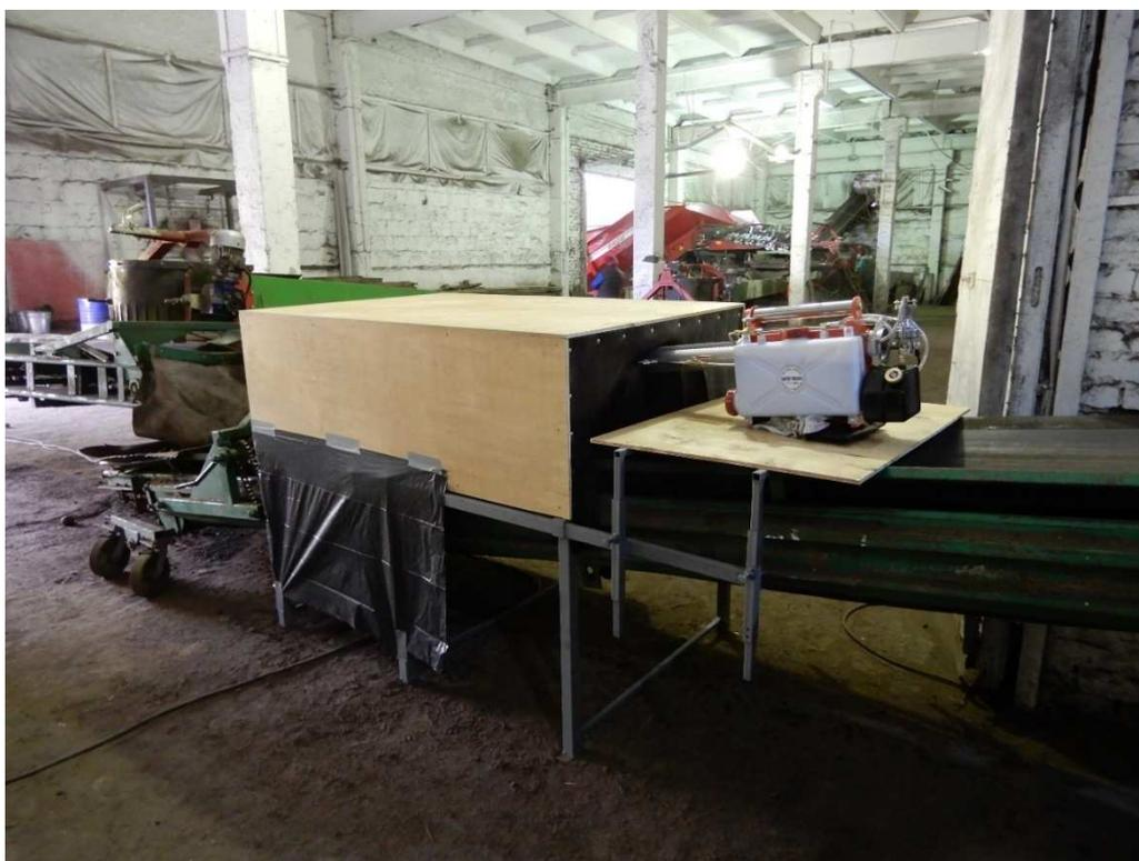
Рисунок 1 – Общий вид линии для предпосадочной обработки картофеля
