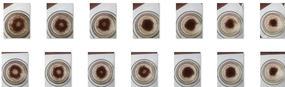
Рис. 4. Последовательность кадров (слева направо) в двух экспериментах демонстрирует изменение распределения взвешенных частиц (чаинок) при уменьшении числа Фруда.
