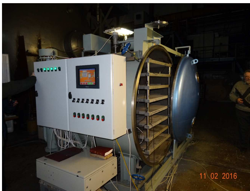
Рисунок 2 – Сублимационная установка УВС-80М. Сушильная камера с пультом управления
