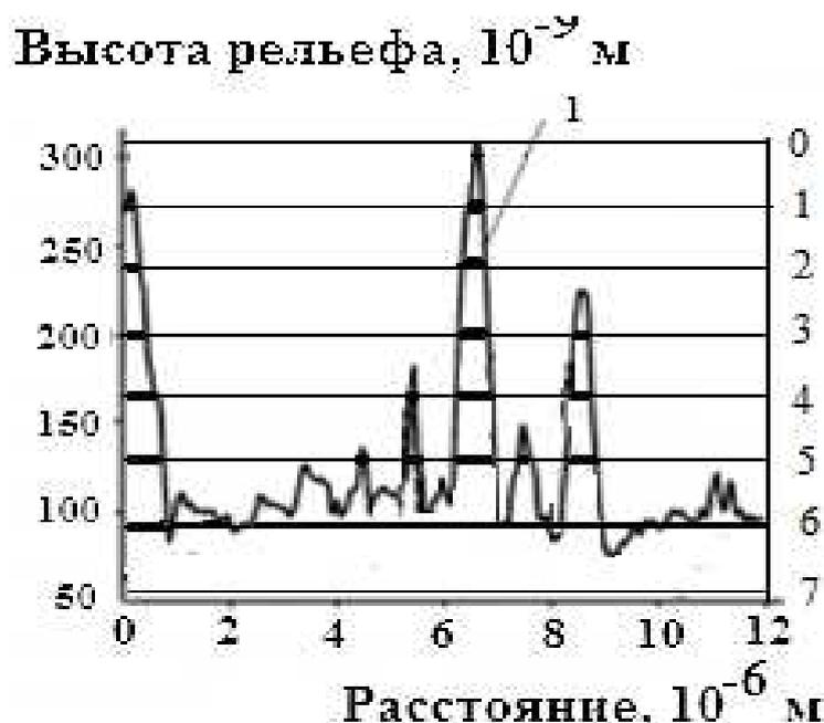
Рис. 8. Микропрофиль мембраны с сечениями в которых рассчитывается долевой объем твердой фазы. Участок на котором проведён расчёт имеет размеры  $12 \times 10^{-12}$  м.
