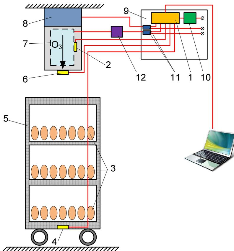
Рисунок 1 – Структурная схема лабораторной установки: 1 – регулятор; 2 – датчик температуры DS18B20; 3 – яйца; 4 – второй датчик концентрации озона; 5 – контейнер для хранения яиц; 6 – первый датчик концентрации озона; 7 – разрядное устройство; 8 – вентилятор; 9 – щит управления, 10 – источник питания; 11 – силовые ключи, 12 – повышающий трансформатор.
