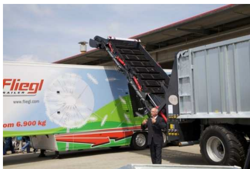
Рисунок 1 – Общий вид перегружающей ленты Fliegl Pom-Over для картофеля, установленной на прицепе - вагоне ASW
