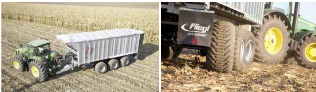
Рисунок 7 – Тракторный поезд с системой электронного принудительного подруливания „ForCon“
