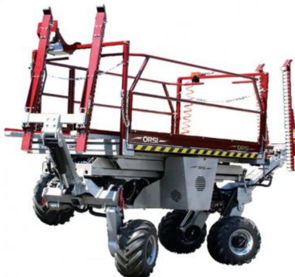
Рисунок 7 – Общий вид самоходной плодуборочной платформы ORSI Cross Eco Südtirol 135
