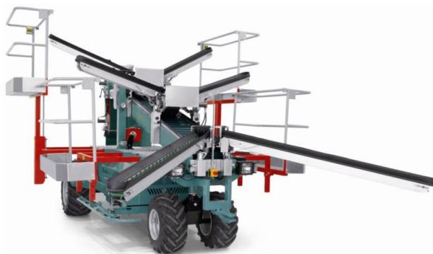
Рисунок 2. - Общий вид самоходной плодуборочной машины Hermes Technofruit CF-110
