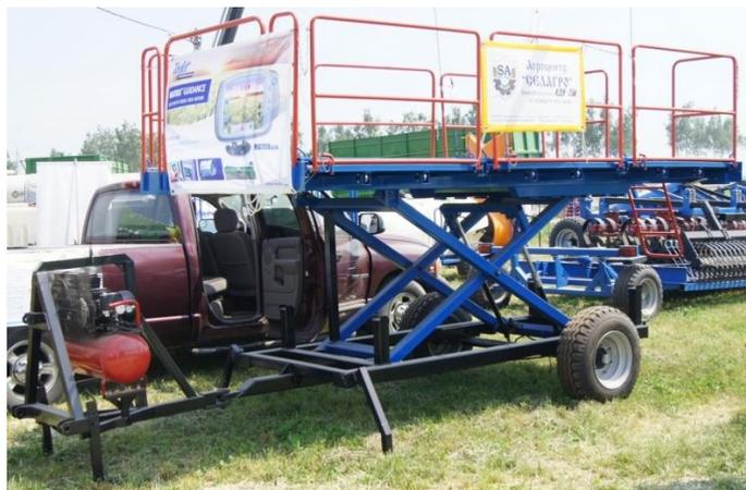
Рисунок 4 – Общий вид прицепной садовой платформы ППСК
