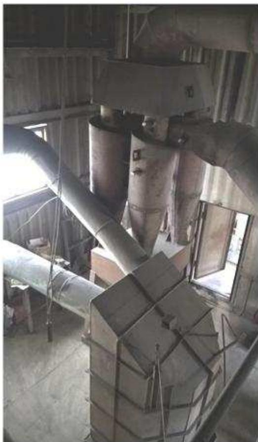
Рисунок 3 – Вид сверху: силос (снизу), циклон (сверху)
