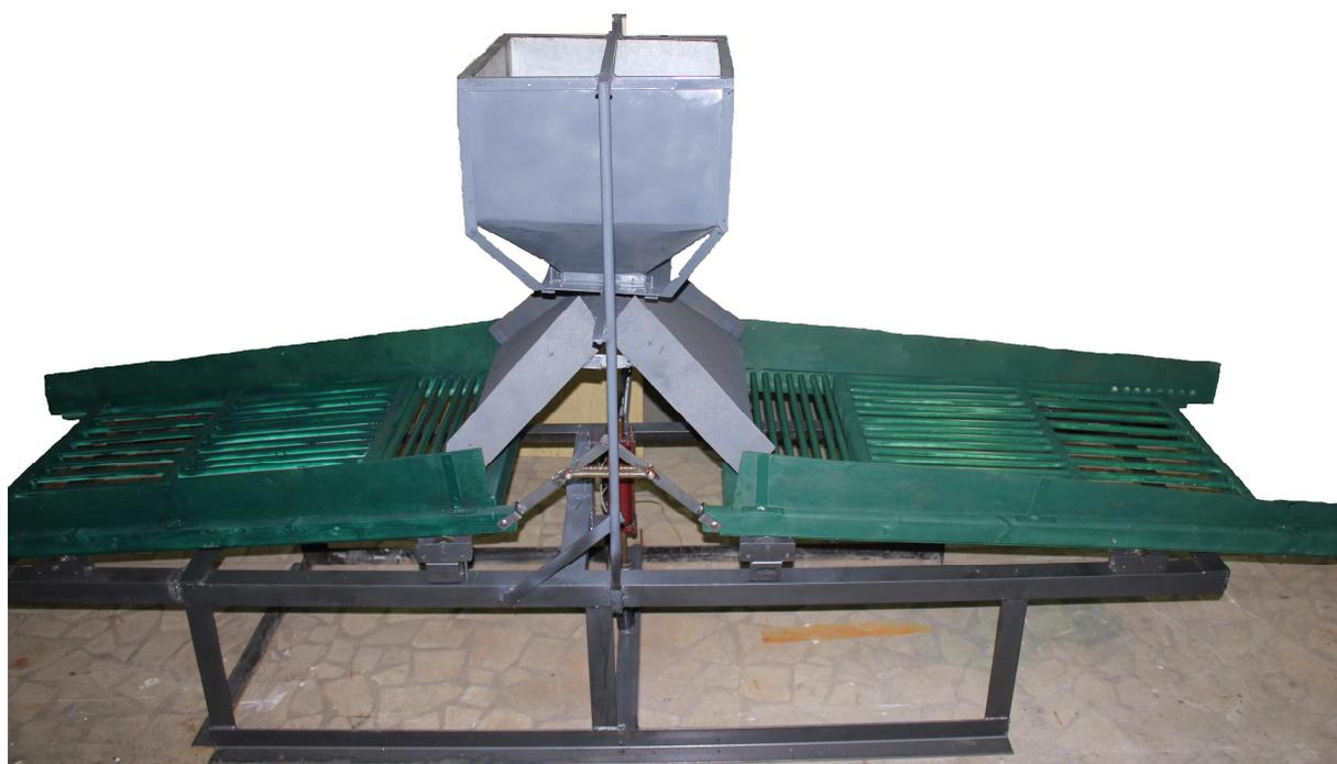
Рисунок 5 Экспериментальная самоуравновешенная картофелесортировальная установка с линейным асинхронным электроприводом
