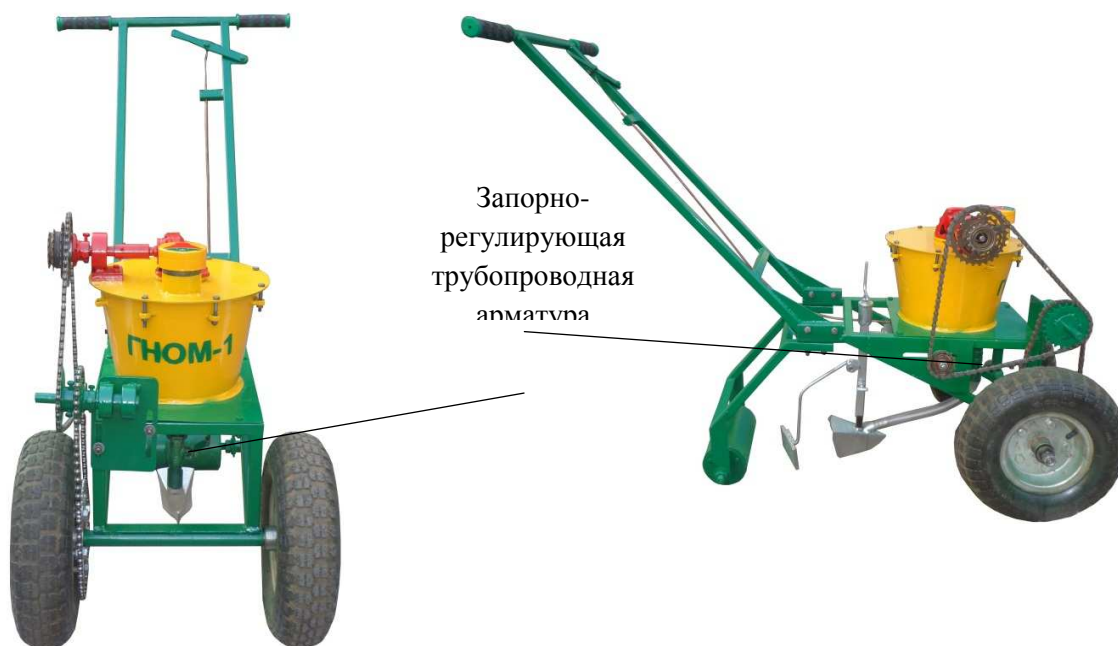
Рисунок 1 – Гидросеялка для посева овощных культур ГНОМ-1
