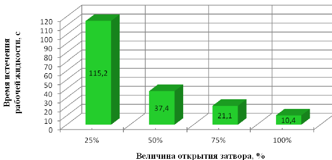
Рисунок 10 – Время истечения рабочей жидкости из кранов: a – 1/2"; б – 3/4"
