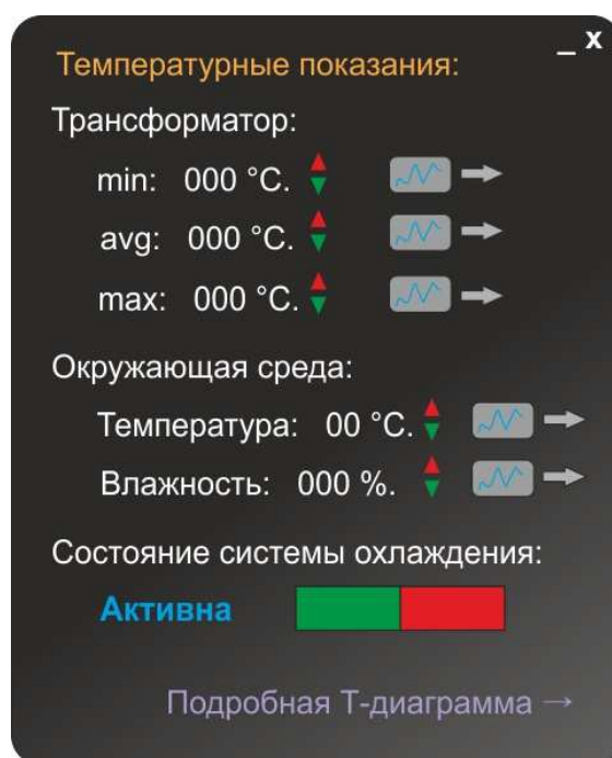
Рисунок 2 – Макет формы для отображения температурных показаний
