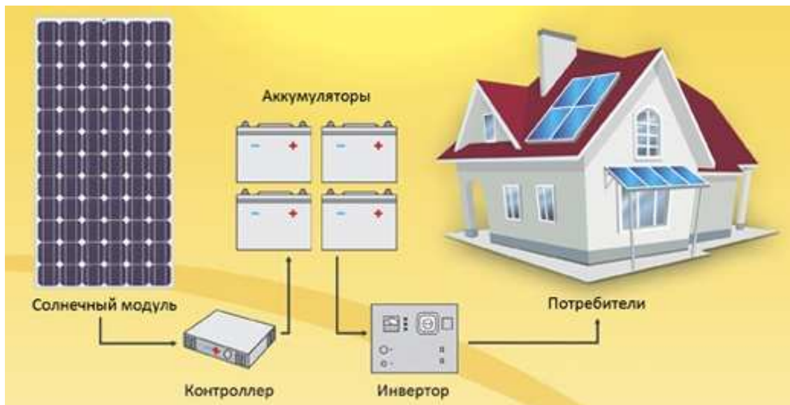
Рисунок 2 – Примерная схема работы системы с солнечной панелью
