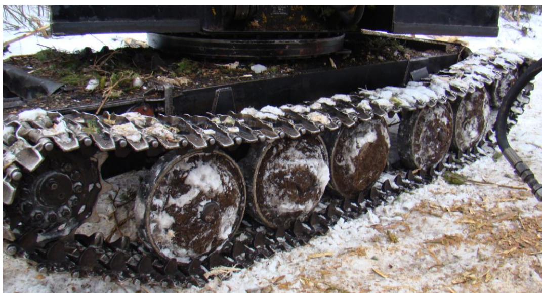
Рисунок 1. Общий вид объекта исследования ходовая система ГЛЗМ на базе тракторов семейства АТЗ
