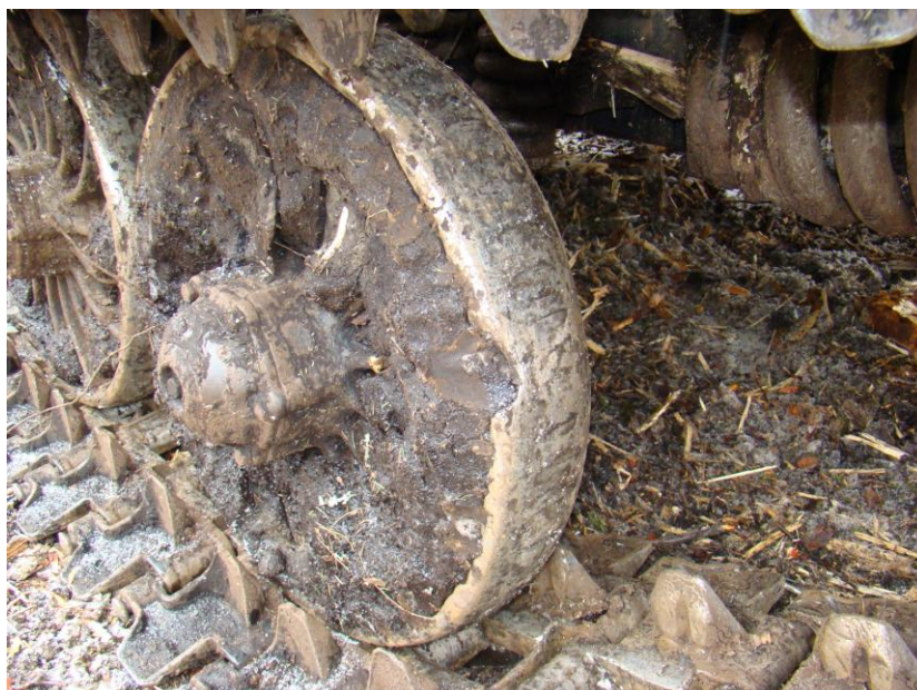
Рисунок 2. Опорный каток ГЛЗМ семейства АТЗ с явными признаками износа
