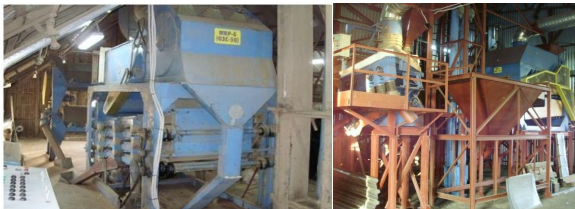
Рисунок 4 – Отделение сортирования с семяочистительной машиной МВУ-1500, пневмостолом МОС-9Н и перегрузчиком 2К (ориг.)
