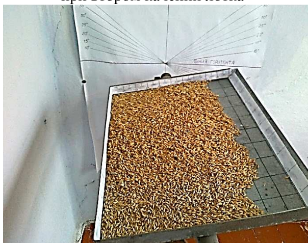
Форма движущегося слоя зерна ячменя при четвертом качении лотка
