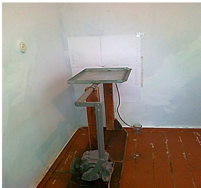
Рисунок 5 – Общий вид экспериментальной гидропонной одноярусной установки с поворачивающимся лотком
