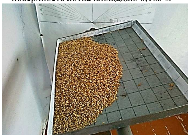
Форма движущегося слоя зерна ячменя при втором качении лотка
