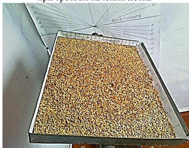
Полное распределение зерна ячменя по поверхности лотка при пятом качении лотка
