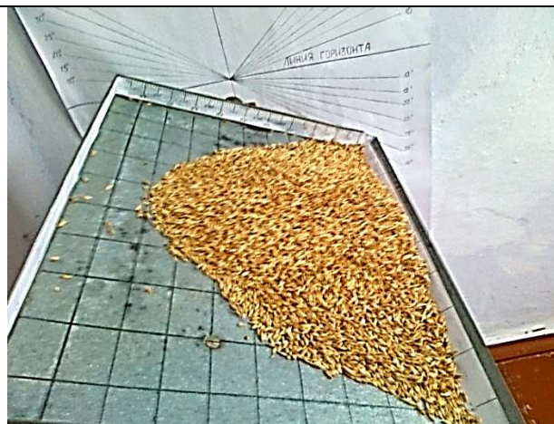
Форма движущегося слоя зерна ячменя при первом качении лотка
