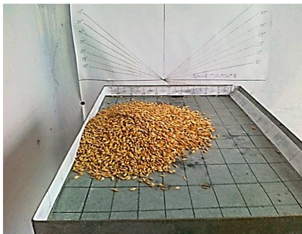
Норма зерна ячменя помещенная на поверхность лотка площадью 0,165 м 2
