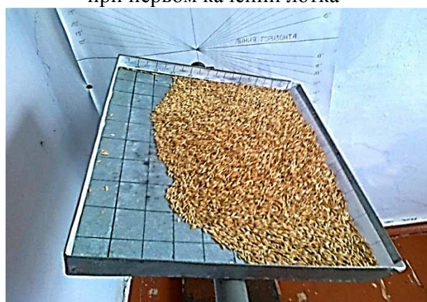
Форма движущегося слоя зерна ячменя при третьем качении лотка
