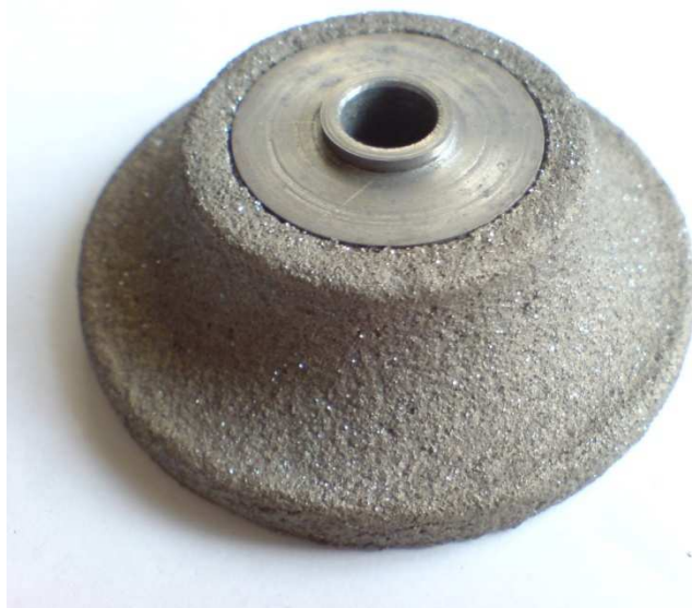
Рис. 4. Внешний вид камнеобрабатывающего алмазного ролика с металлической связкой Sn-Cu-Co-W
