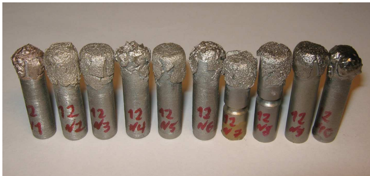
Рис. 1. Растрескивание композиционных припоев Sn-Cu-Co и Sn-Co (спекание в аргоне при 1100 °С, 20 мин)
