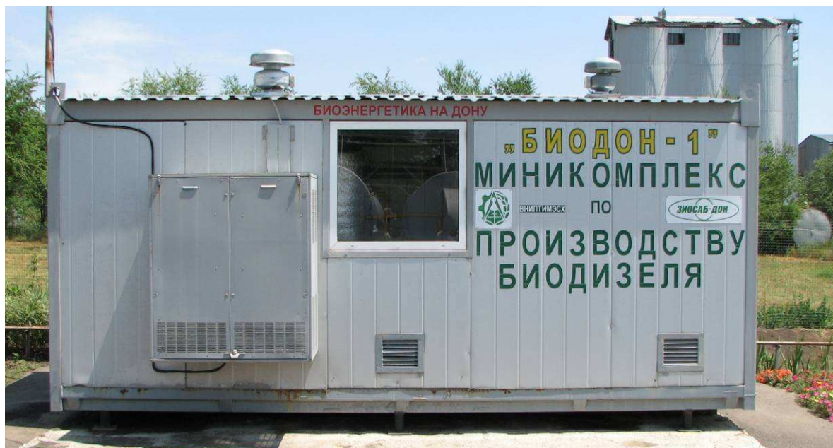
Рисунок 2 - Модульная установка для производства биотоплива
