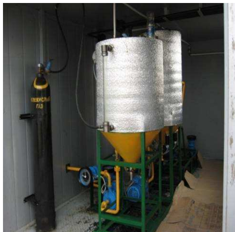
Рисунок 1 – Модули для производства биотоплива из растительного масла:
