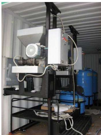
Рисунок 1 – Модули для производства биотоплива из растительного масла:
