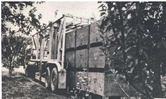
Рисунок 6 - Контейнеровоз с П-образной рамой (США)
