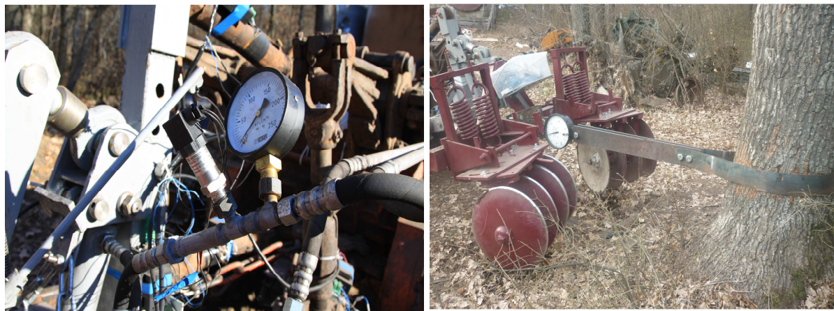
Рис. 10. Датчик давления рабочей жидкости в гидроцилиндре приспособления а и тарирование тензометрических датчиков для измерения усилий в тягах навесного устройства трактора б
