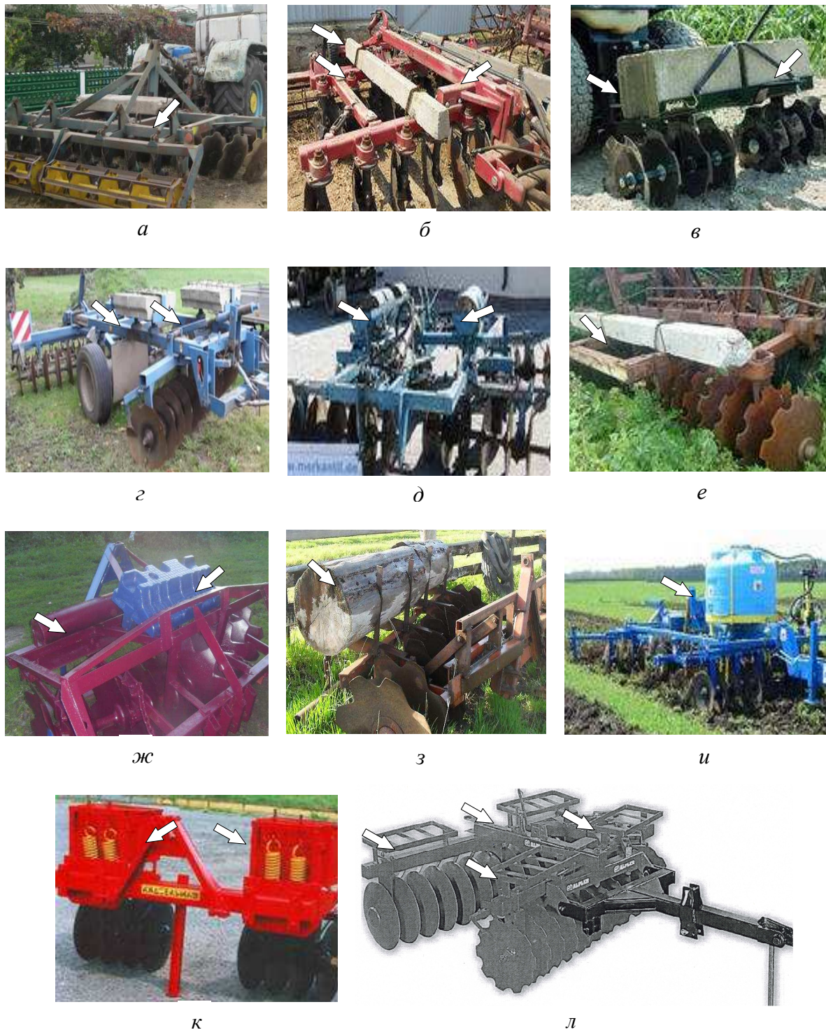
Рис. 1. Повышение заглабляющей способности дисковых орудий с помощью закрепленных на их рамах (показано стрелками): а ... е – бетонных блоков; ж – металлических догрузателей; з – бревна; и – емкости с жидкостью для полива, химзащиты или подкормки; к – ящиков с балластом; л – площадок для крепления грузов
