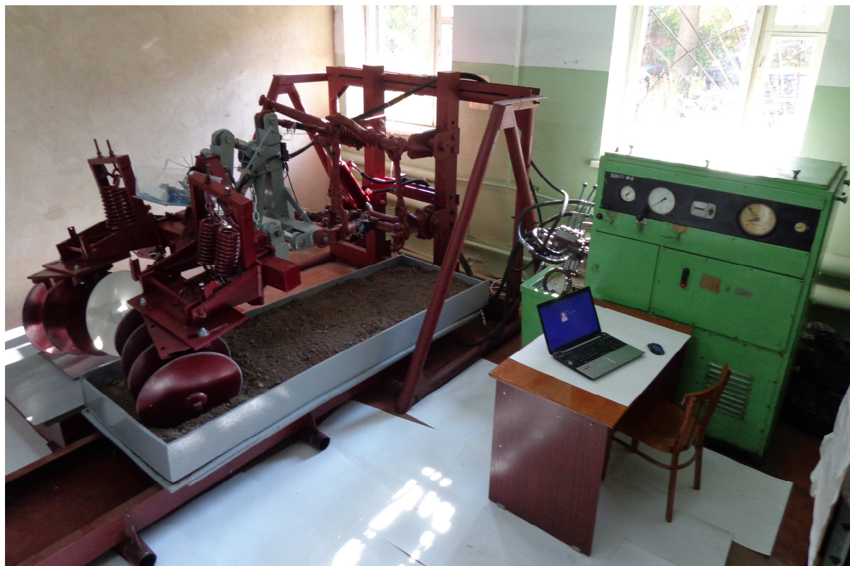
Рис. 6. Рабочий момент эксперимента на испытательном стенде опытного образца гидравлического приспособления к навесному устройству трактора с навешенным на нем серийным лесным дисковым культиватором КЛБ-1,7
