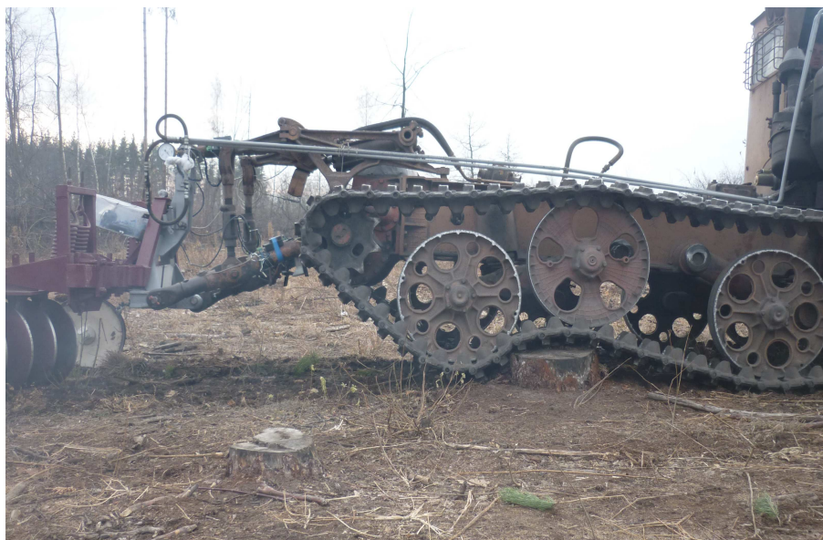
Рис.12. Выглубление дисковых батарей культиватора без приспособления при наезде трактора на пни
