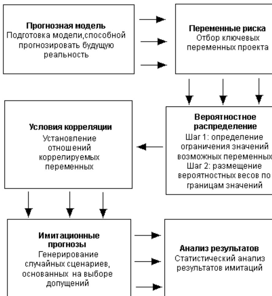
Рисунок 2 – Укрупненная блок-схема имитационного моделирования
