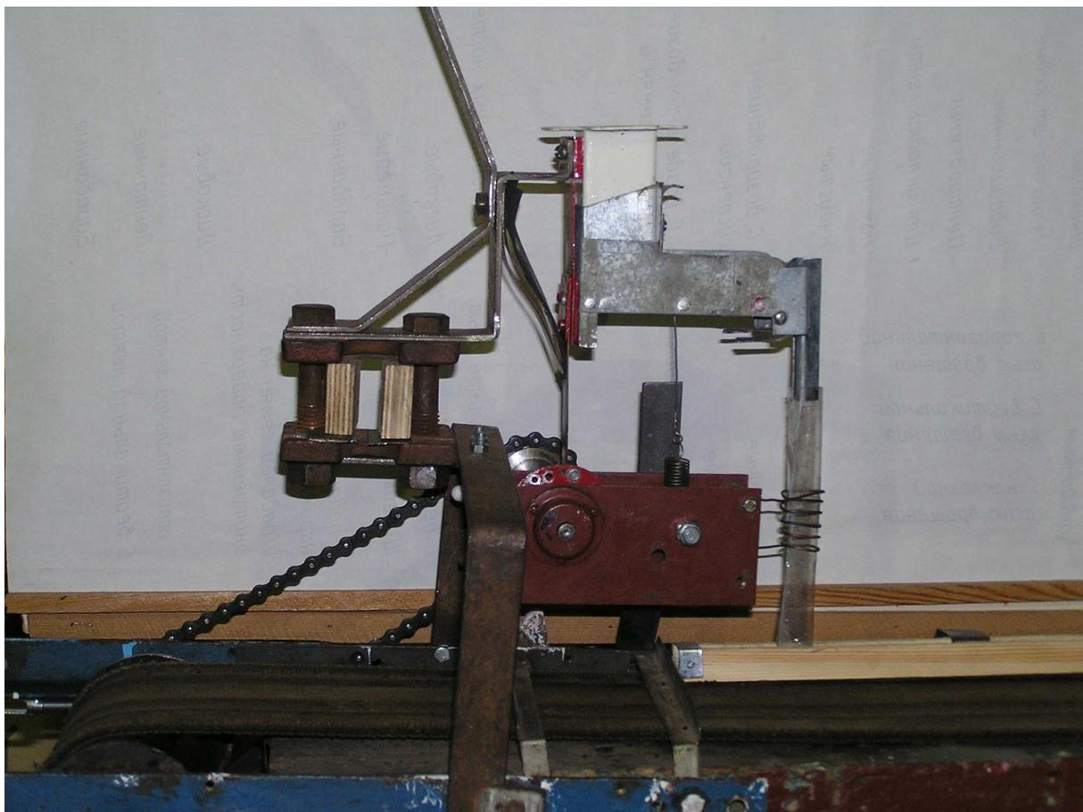
Рисунок 1 – Лабораторная установка с импульсным высевающим аппаратом
