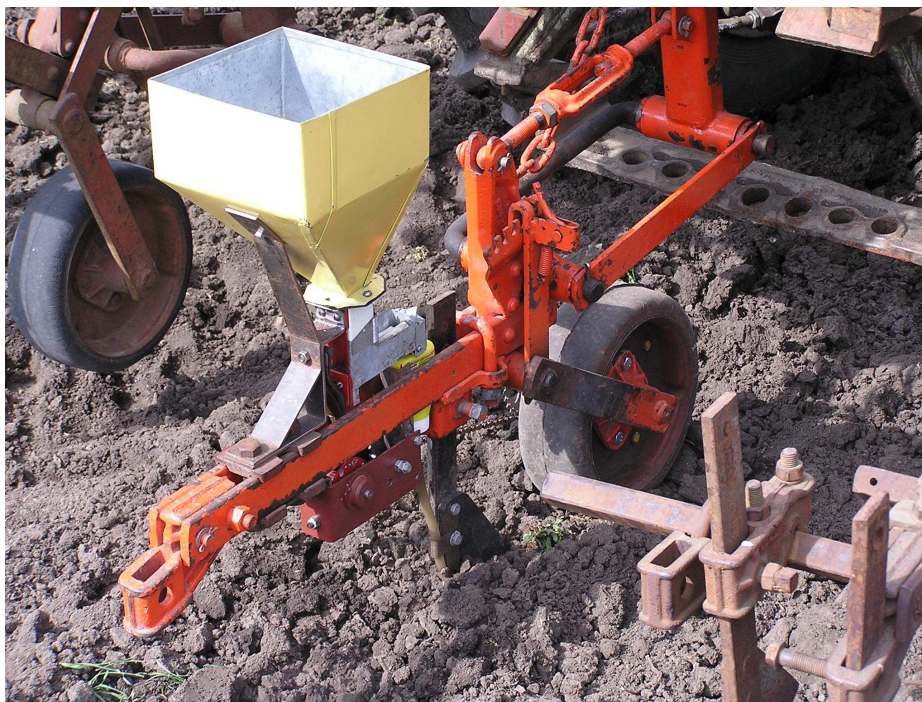
Рисунок 9 – Производственная установка для высева лука севка в полевых условиях:
