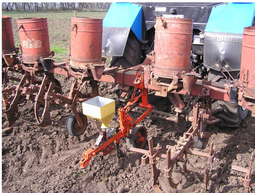
Рисунок 8 – Производственная установка для посева лука севка в полевых условиях
