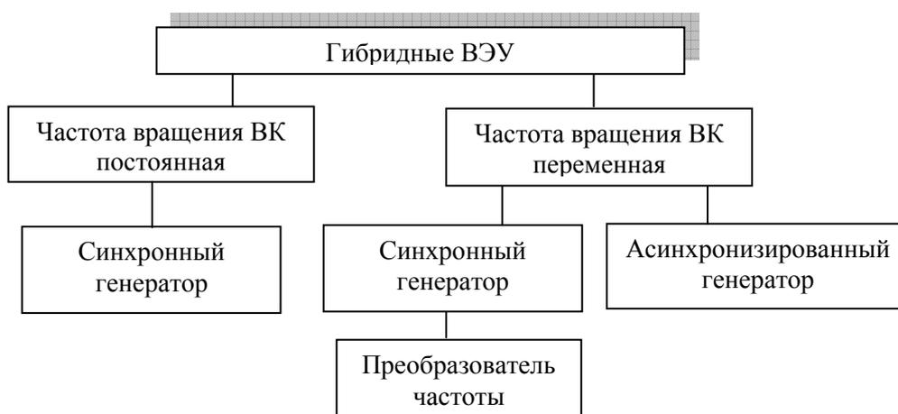
Рисунок 3 – Структурная схема системных ВЭУ
