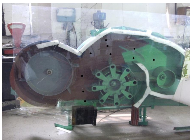
Рисунок 2 - Двухбарабанный вариант лабораторной установки
