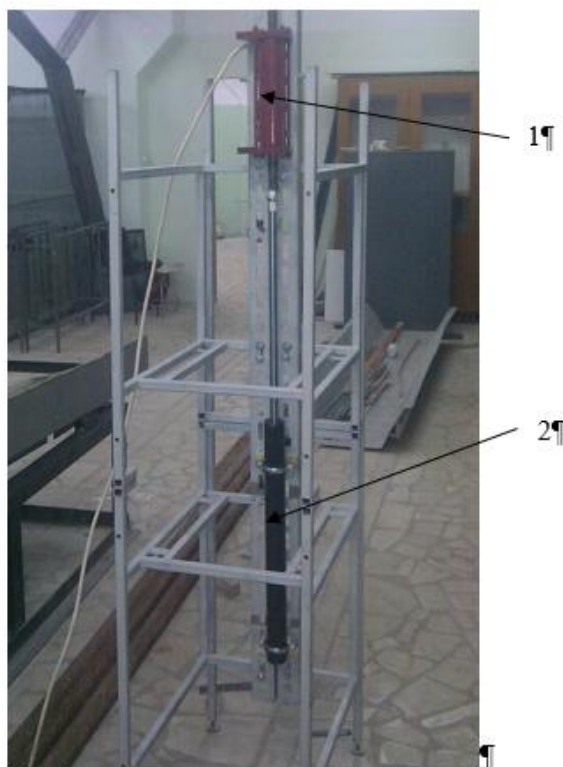
Рисунок 5 Лабораторная установка плунжерного насоса с ЦЛАД
