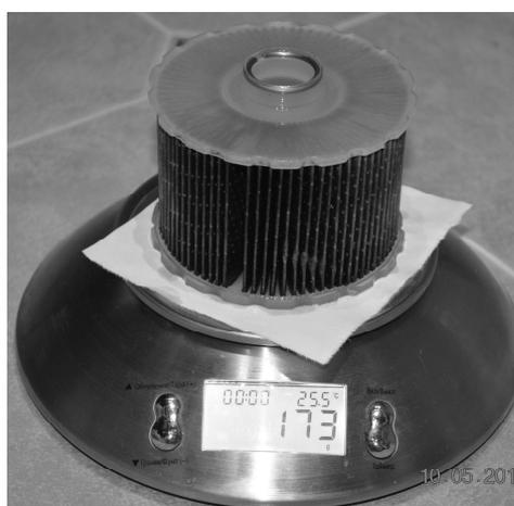
Рисунок 9 - Измерение массы фильтра с пробегом 20000 км
