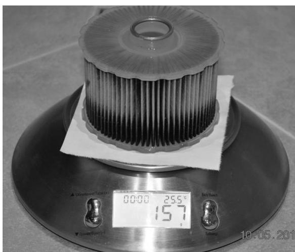
Рисунок 8 - Измерение массы фильтра с пробегом 10000 км
