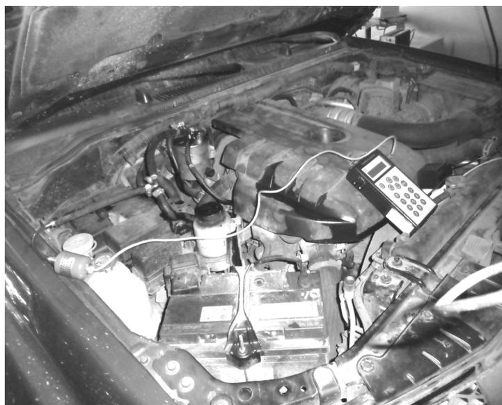
Рисунок 11 - Измерение калибратором давления "Метран" разряжения в топливопроводе автомобиля
