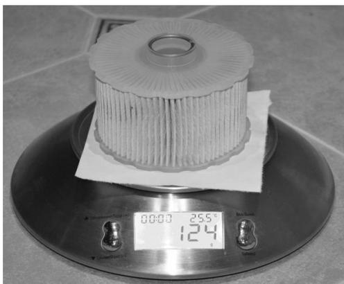
Рисунок 7 - Измерение массы нового фильтра после заполнения топливом и последующей просушки
