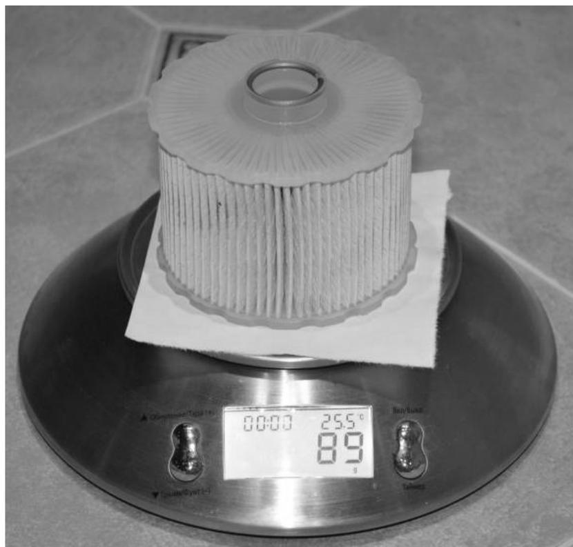
Рисунок 6 - Измерение массы нового фильтра
