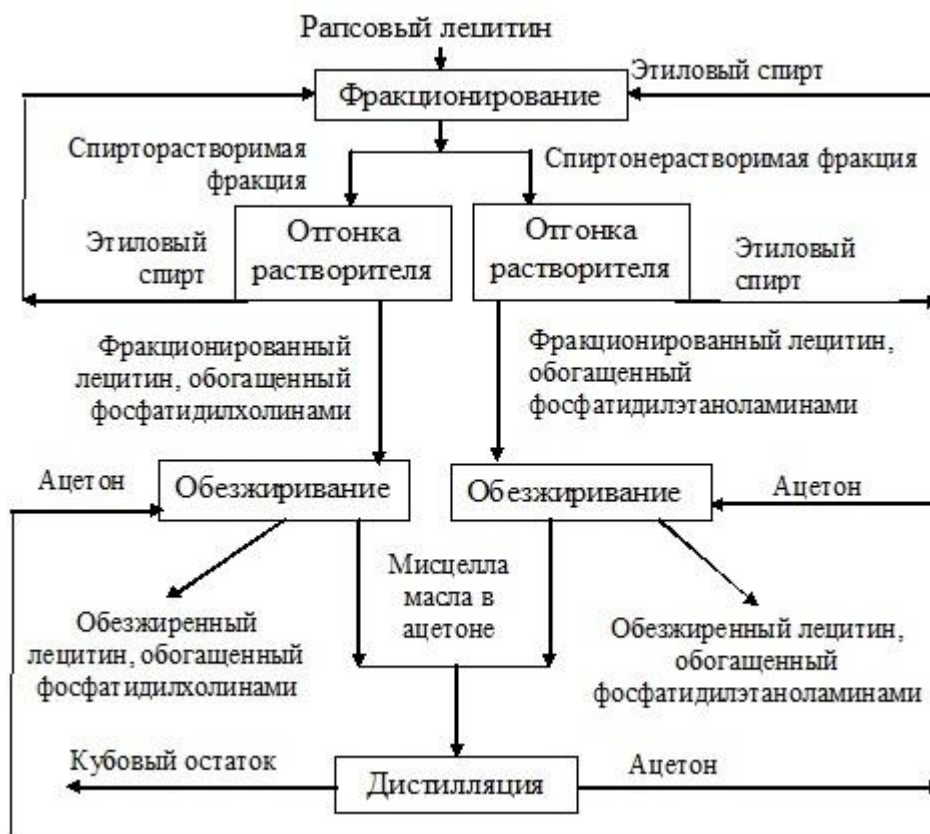
Рисунок 4 – Схема получения рапсовых лецитинов с повышенным содержанием функциональных групп фосфолипидов
