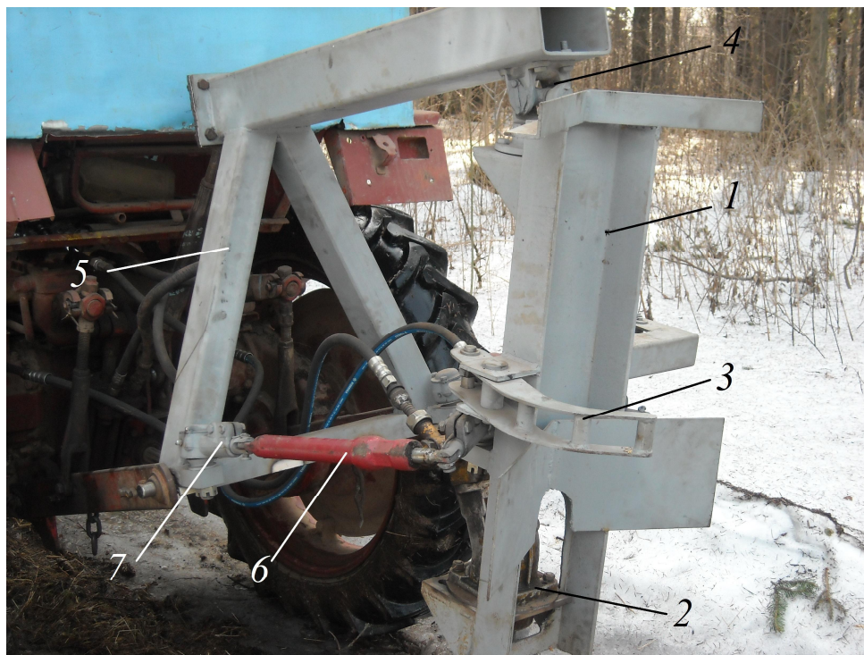
Рисунок 1 - Экспериментальный образец ЗСУ на задней навеске трактора Т-25
