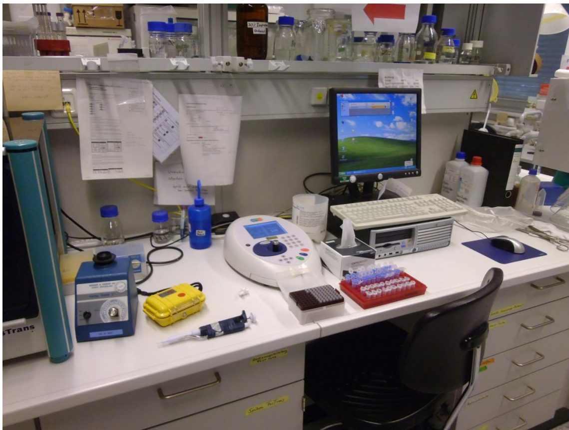
Рис. 4. Определение концентрации ДНК при помощи спектрофотометра IMPLEN.
