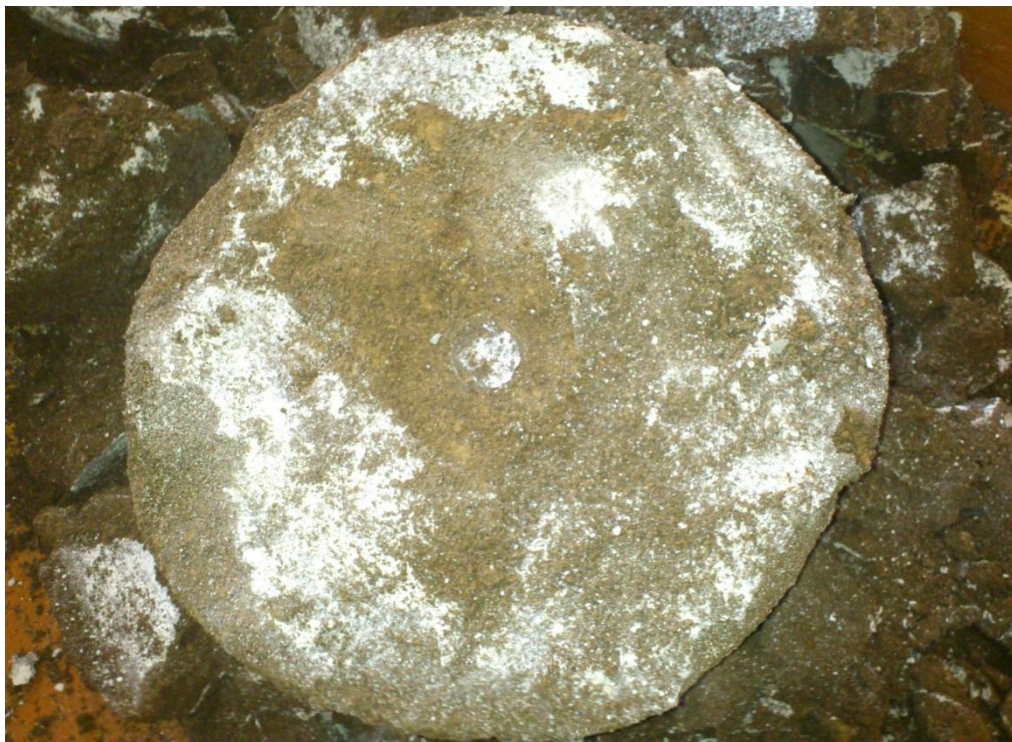
Рисунок 5 - Горизонтальный срез под нижним концом сваи
