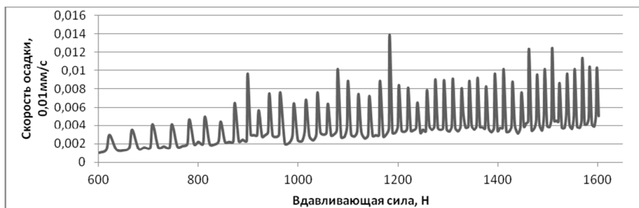
Рисунок 10 - Участок графика зависимости скорости осадки от нагрузки, соответствующий II стадии осадки сваи.
