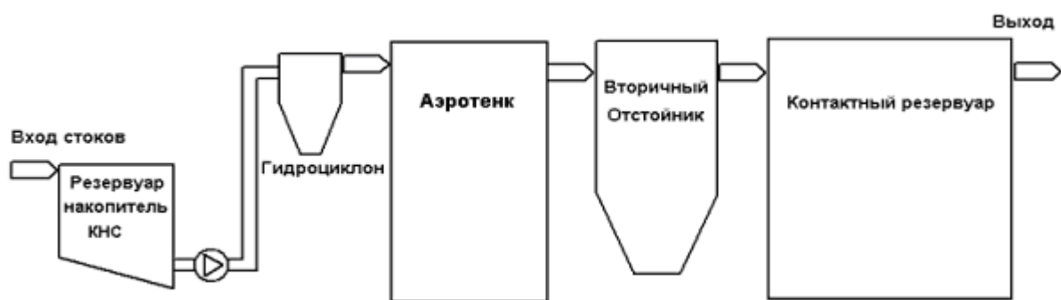
Рис. 8. Упрощённая схема КОС «Пионерный».
