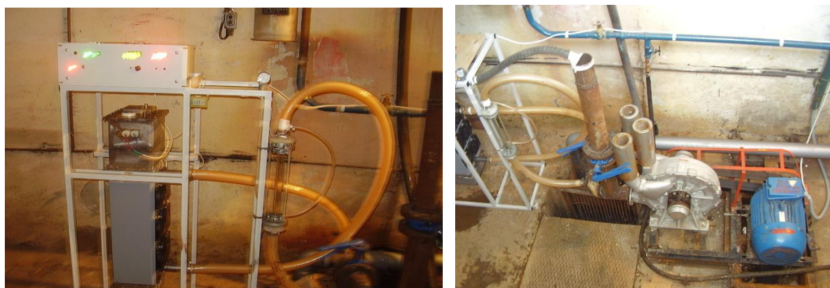
Рис. 5. Озонатор с ротаметром и разводкой, и подключение воздуходувки ЭФ-103
