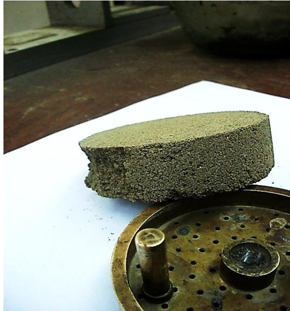
Рисунок 3 – Поверхности скольжения (слева) идут от торцов и пересекаются в средней по высоте части образца
