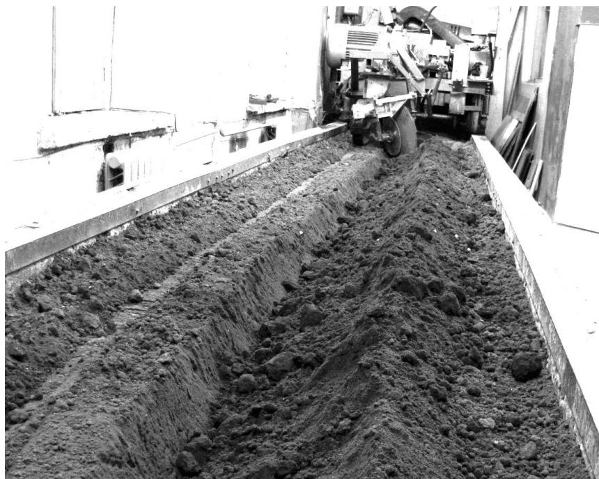
Рисунок 1 – Вид борозды, образованный дисковым рабочим органом в почвенном канале ВГЛТА
