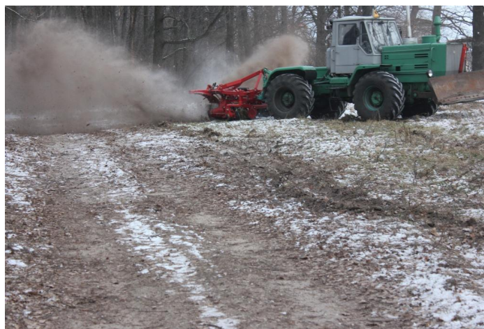
Рисунок 8 – Лесопожарная комбинированная грунтометательная машина во время проведения полевых испытаний
