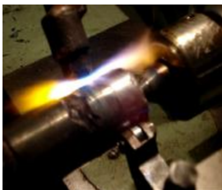
Рисунок 2 – Обработка нагретой поверхности детали охлаждаемым водой роликовым накатником с шириной кольца роликового подшипника 11 мм
