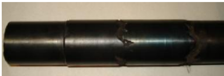
Рисунок 5 – Фотография поверхности детали обработанной резанием с нагревом и последующей ППД с подачей охлаждающей жидкости на вращающийся ролик
