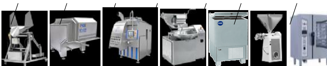
Рисунок 2. Компоновка основного оборудования для производства мясных и рыбных колбас: 1 – загрузочное устройство, 2 – блокорежка, 3 – смеситель, 4 – куттер, 5 – льдогенератор, 6 – шприц, 7 – пароконвектомат
