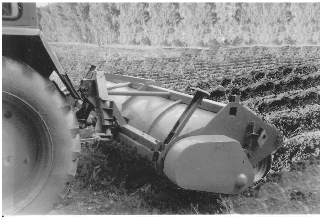
Рисунок 4. Модернизированный ботводробитель БД - 4М.
