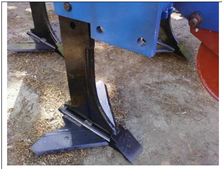
Рисунок 2 – Рабочий орган ПСЧ-3,5 в положении «Плоскорез»
