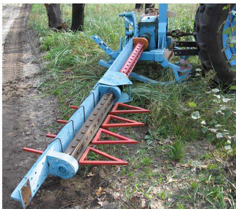
Рис. 2. Общий вид кустореза с упорами-улавливателями порослевин и без подпора
