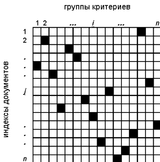
Рисунок 2 - План назначений - матрица нейронной сети Хопфилда в состоянии покоя
