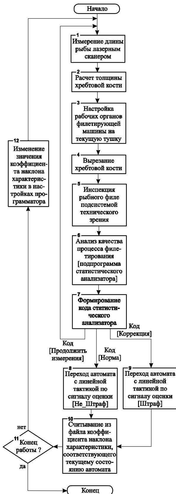
Рисунок 6 – Блок-схема упрощенного алгоритма адаптации процесса филетирования
