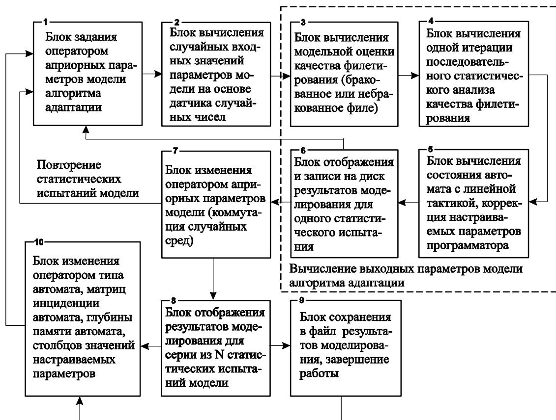
Рисунок 7 – Схема моделирования алгоритма адаптации с использованием метода Монте-Карло (процедурная последовательность)
