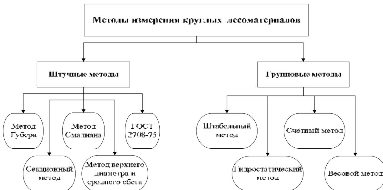
Рис. 1 Классификация методов измерения объема круглого леса по количеству измеряемых лесоматериалов за один цикл измерения
