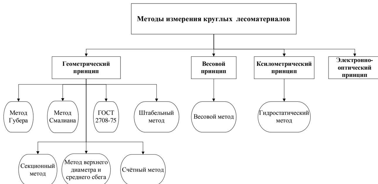
Рис. 2 Классификация методов измерения объема круглого леса по принципу измерения
