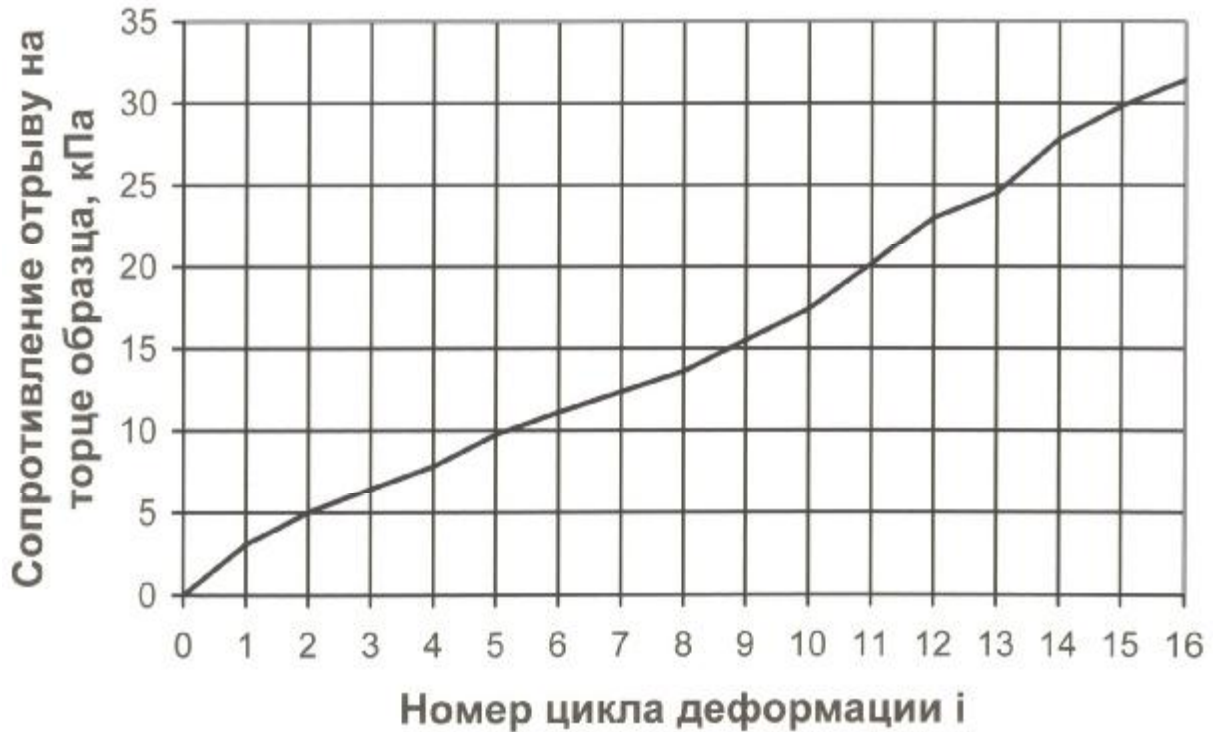
Рисунок 9 – Увеличение сопротивления грунта отрыву на торце образца при возрастании давления до \sigma_{str} в 16-ти циклах деформации
