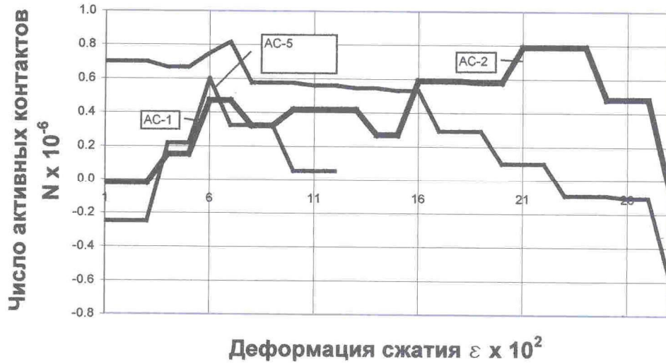
Рисунок 3 – Изменение числа активных контактов при увеличении деформации сжатия образцов AC-1, AC-2 и AC-5
