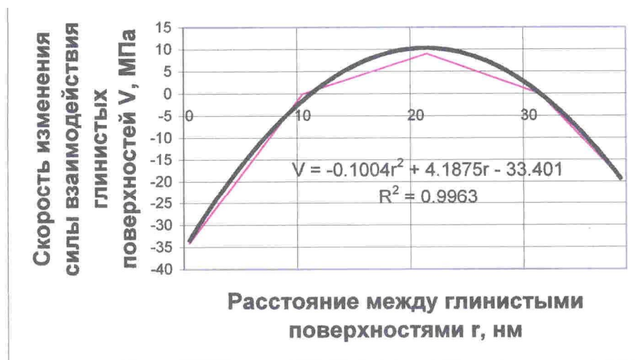
Рисунок 2 – Кривая скорости изменения реакции образца, построенная по амплитудным значениям H , C и G (образец АС-9)
